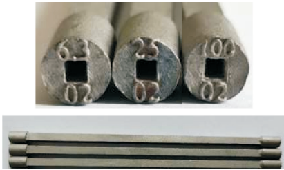
图 2 粗糙度不同的 3D 打印矩形通道照片 Fig. 2 Photos of 3D printed rectangle channel with different roughness
